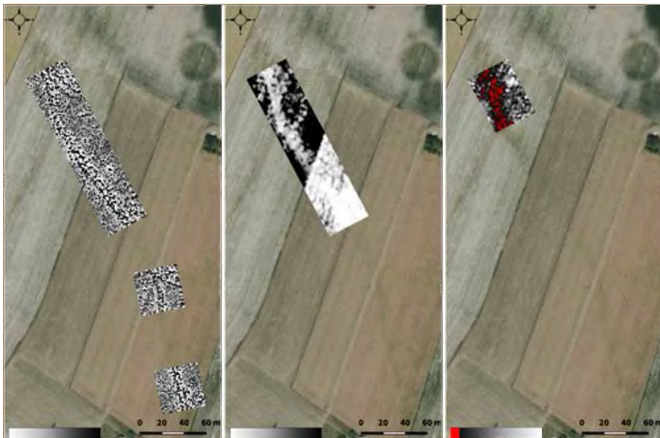
Ryc. 5. | Okopy, gm. Nowa Sucha. Wizualizacja pomiarów geofizycznych. Po lewej – pomiary magnetyczne; środek – pomiary elektrooporowe; po prawej – pomiary georadarowe (4-7 ns). (Źródło: fotografia lotnicza z zasobu danych APP).
